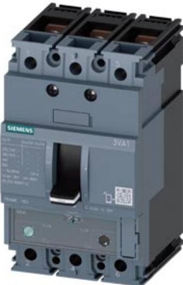
Disjoncteur 3VA1 CEI cadre 160 classe de coupure M Icu=55kA à 415V 3 pôles, protection des installations TM240, In=50A protection contre les surcharges Ir=35A...50A protection contre les courts-circuits Ii=5...10 x In plage de raccordement par vis 2 interrupteurs auxiliaires HQ 1 indicateur de déclenchement HQ
