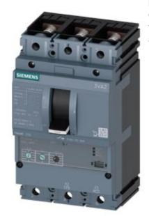
Disjoncteur 3VA2 CEI Frame 250 classe de coupure M Icu=55kA à 415V 3 pôles, protection de moteur ETU350M, LSI, In=200A protection contre les surcharges Ir=80A...200A protection contre les courts-circuits Isd=3...15 x Ir, Ii=15 x In plage de raccordement par vis déclencheur à minimum de tension (UVR) 24V CC 2 interrupteurs auxiliaires HQ 1 indicateur de déclenchement HQ
