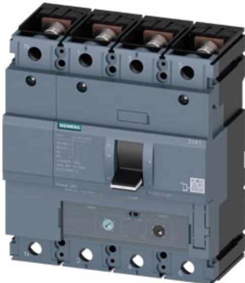
Disjoncteur 3VA1 CEI Frame 250 Classe de coupure S Icu=36 kA à 415 V 4 pôles, protection des installations TM240, ATAM, In=250A Protection contre les surcharges Ir=175A...250A Protection contre les courts-circuits Ii=5...10 x In Conducteur neutre non protégé Plage de raccordement par vis 2 interrupteurs auxiliaires HQ
