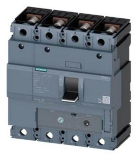
Disjoncteur 3VA1 CEI Cadre 250 Classe de coupure S Icu=36 kA à 415 V 4 pôles, protection des installations TM240, ATAM, In=250A Protection contre les surcharges Ir=175A...250A Protection contre les courts-circuits Ii=5...10 x In Protection du neutre 100% Plage de raccordement par vis 1 interrupteur auxiliaire HQ 1 indicateur de déclenchement HQ
