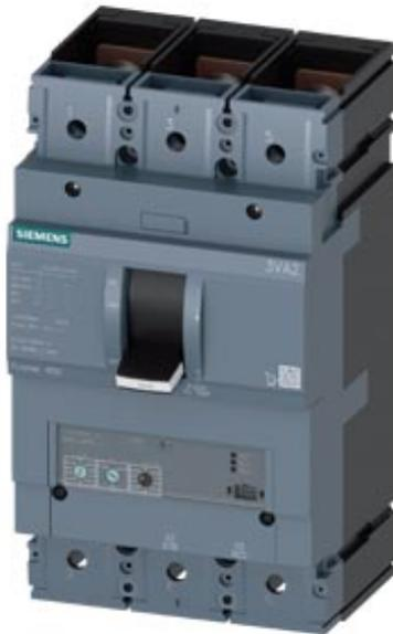
Disjoncteur 3VA2 CEI Frame 400 classe de coupure C Icu=110kA à 415V 3 pôles, protection de moteur ETU350M, LSI, In=250A protection contre les surcharges Ir=100A...250A protection contre les courts-circuits I<sub>sd</sub>=3...15 x I<sub>r</sub>, I<sub>i</sub>=15 x I<sub>n</sub> plage de raccordement par vis déclencheur à minimum de tension (UVR) 120-127V CA 50/60Hz 2 interrupteurs auxiliaires HQ 1 indicateur de déclenchement HQ 1 contact de signalisation de déclencheur de protection
