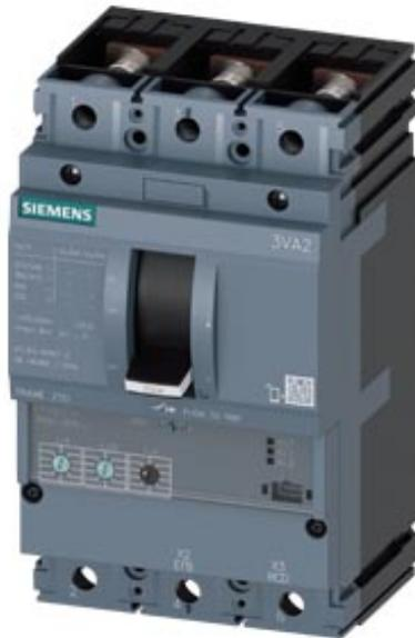
Disjoncteur 3VA2 CEI Frame 250 classe de coupure M Icu=55kA à 415V 3 pôles, protection des installations ETU320, LI, In=250A protection contre les surcharges Ir=100A...250A protection contre les courts-circuits Ii=1,5...10 x In plage de raccordement par vis déclencheur à minimum de tension (UVR) 24V CC 2 interrupteurs auxiliaires HQ 1 indicateur de déclenchement HQ 1 contact de signalisation de déclencheur de protection
