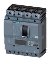
Leistungsschalter 3VA2 IEC Frame 160 Schaltvermögenklasse M lcu=55kA @ 415V 4-polig, Anlagenschutz ETU860, LSIG, ln=40A Überlastschutz Ir=16A...40A Kurzschlussschutz Isd=0,6..10x ln, li=1,5..12x ln N-Leiterschutz einstellbar (OFF, bis 160%) Erdschlussschutz, abschaltbar Ig=0,4...1 x ln= tg=0,05-0,8s Klemmenanschluss
