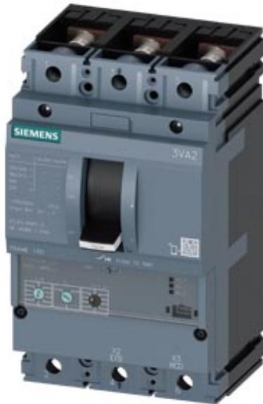
Disjoncteur 3VA2 CEI Frame 160 classe de coupure M Icu=55kA à 415V 3 pôles, protection de moteur ETU350M, LSI, In=40A protection contre les surcharges Ir=16A...40A protection contre les courts-circuits I<sub>sd</sub>=3...15 x I<sub>r</sub>, I<sub>i</sub>=15 x I<sub>n</sub> plage de raccordement par vis déclencheur à minimum de tension (UVR) 24V CC 2 interrupteurs auxiliaires HQ 1 indicateur de déclenchement HQ 1 contact de signalisation de déclencheur de protection
