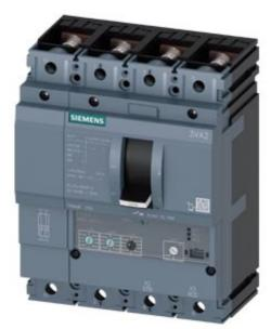
Disjoncteur 3VA2 CEI Frame 250 classe de coupure M Icu=55kA à 415V 4 pôles, protection des installations ETU320, LI, In=250A protection contre les surcharges Ir=100A...250A protection contre les courts-circuits Ii=1,5...10 x In protection du neutre réglable (OFF, 50%, 100%) plage de raccordement par vis déclencheur à minimum de tension (UVR) 120-127V CA 50/60Hz 2 interrupteurs auxiliaires HQ 1 indicateur de déclenchement HQ
