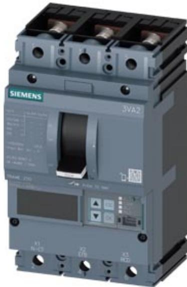
Disjoncteur 3VA2 CEI Frame 250 classe de coupure M Icu=55kA à 415V 3 pôles, protection des installations ETU560, LSIG, In=250A protection contre les surcharges Ir=100A...250A protection contre les courts-circuits Isd=0,6..10x In, li=1,5..10x In protection du neutre en option avec transformateur de courant protection de court-circuit à la terre, désactivable Ig=0,2...1 x In, tg=0,05-0,8s plage de raccordement par vis déclencheur voltmétrique (STL) 12-30V CC; 24V CA 50/60Hz
