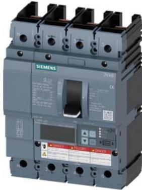
Leistungsschalter 3VA6 UL Frame 250 Schaltvermögenklasse H 65kA @ 480V 4-polig, Anlagenschutz ETU860, LSIG, In=100A Überlastschutz, 100% rated Ir=40A...100A Kurzschlusschutz Isd=0,6..10x In, li=1,5..12x In N-Leiterschutz einstellbar (OFF, bis 160%) Erdschlusschutz Ig=0,2...1 x In= tg=0,05-0,8s ohne Anschluss
