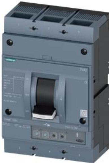
Disjoncteur 3VA2 CEI cadre 1000 classe de coupure H Icu=85kA à 415V 3 pôles, protection des installations ETU350, LSI, In=1 000A protection contre les surcharges Ir=400A...1 000A protection contre les courts-circuits I<sub>sd</sub>=1,5...10 x I<sub>r</sub>, I<sub>i</sub>=10 x I<sub>n</sub> plage de raccordement par vis déclencheur à minimum de tension (UVR) 208-230V CA 50/60Hz 2 interrupteurs auxiliaires HQ
