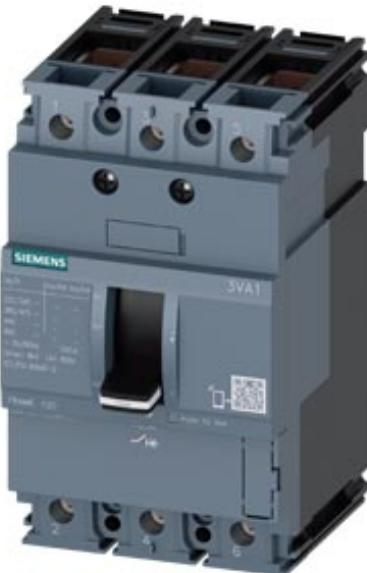
Disjoncteur 3VA1 CEI Cadre 100 classe de coupure B Icu=16kA à 415V 3 pôles, protection des installations TM210, FTFM, In=63A protection contre les surcharges Ir=63A réglage fixe protection contre les courts-circuits Ii=10 x In raccordement par bornes déclencheur voltmétrique (STL) 12-30V CC, 24V CA 50/60Hz 2 interrupteurs auxiliaires HQ
