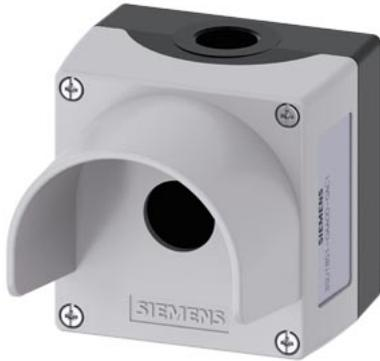
Gehäuse für Befehlsgeräte, 22 mm, rund, Gehäusematerial Metall, Gehäuseoberteil grau, mit Schutzkragen, 1 Befehlsstelle, ohne Bestückung, Bodenbefestigung, oben und unten je 1xM20
