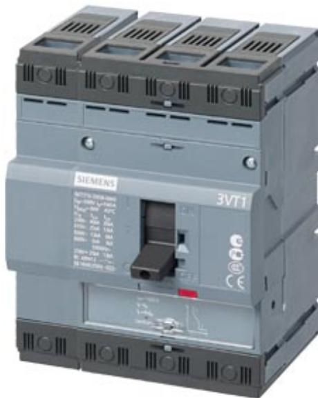
Disjoncteur 3VT1 pouvoir de coupure standard  $I_{cu}=25\text{kA}$ , 415V CA 4 pôles, protection des installations déclencheur à maximum de courant TM,  $I_{L}=32\text{ A}$  courant assigné  $I_{R}=25\ldots32\text{A}$  protection contre les surcharges  $I_{II}=160\ldots320\text{A}$ , protection contre les courts-circuits conducteur neutre non protégé sans déclencheur auxiliaire sans contact auxiliaire/d'alarme avec raccordements avant
