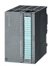
SIMATIC S7-300, Zählerbaugruppe FM 350-2, 8 Kanäle, 20 kHz, 24V-Geber zum Zählen, Frequenz- Messung, Drehzahlmessung, Periodendauermessung, Dosieren inkl. Projektierpaket und elektronischer Doku auf CD-ROM
