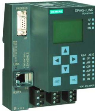
SIMATIC NET, DP/AS-Interface Link advanced, Netzübergang PROFIBUS-DP/AS-Interface mit Master-Profil M3, M4 gemäß AS-i Spezifikation V3.0 für die Einbindung in PROFIBUS-DP, Doppelmaster mit Display, Schutzart IP20
