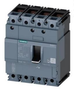
Disjoncteur 3VA1 CEI Cadre 100 classe de coupure S Icu=36kA à 415V 4 pôles, protection des installations TM210, FTFM, In=63A protection contre les surcharges Ir=63A réglage fixe protection contre les courts-circuits li=10 x ln conducteur neutre non protégé plage de raccordement par vis déclencheur voltmétrique (STL) 12-30V CC; 24V CA 50/60Hz
