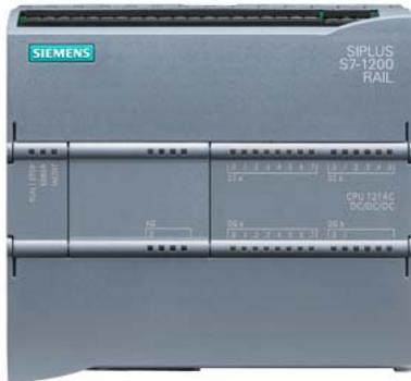
SIPLUS S7-1200 CPU 1214C DC/DC/DC T1 RAIL based on 6ES7214-1AG40-0XB0 mit Conformal Coating, -25...+60°C, OT1 mit ST1/2 (+70°C für 10min), Kompakt-CPU, DC/DC/DC, onboard I/O: 14 DI DC 24V; 10 DO 24V DC; 2 AI 0-10V DC, Stromversorgung: 20,4-28,8V DC, Programm-/Datenspeicher 75 KB
