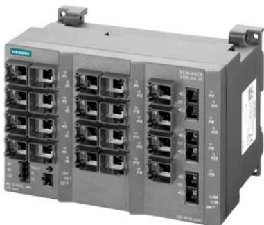
SCALANCE X320-3LDFE managed IE Switch, 20x 10/100 Mbit/s RJ45 Ports, 1x 100 Mbit/s SC Port MM 2x 100 Mbit/s SC Port SM LED-Diagnose, Fehlermelde- Kontakt mit Select/Set-Taster, PROFINET IO Device, Netzwerk- Management, integrierter Redundanz-Manager, Office Features (RSTP, VLAN, IGMP,...) C-PLUG im Lieferumfang.
