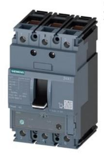
Disjoncteur 3VA1 CEI cadre 160 classe de coupure S Icu=36kA à 415V 3 pôles, protection des installations TM240, ATAM, In=125A protection contre les surcharges Ir=88A...125A protection contre les courts-circuits li=5...10 x In raccordement par bornes Déclencheur voltmétrique (STL) 110-127V CC, 50/60Hz CA
