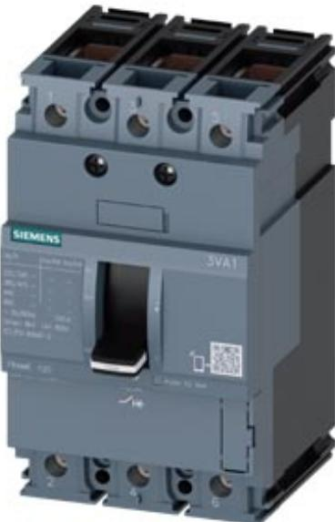
Disjoncteur 3VA1 CEI Cadre 100 classe de coupure B Icu=16kA à 415V 3 pôles, protection des installations TM210, FTFM, In=20A protection contre les surcharges Ir=20A réglage fixe protection contre les courts-circuits li=16 x In raccordement par bornes déclencheur à minimum de tension (UVR) 24V CC
