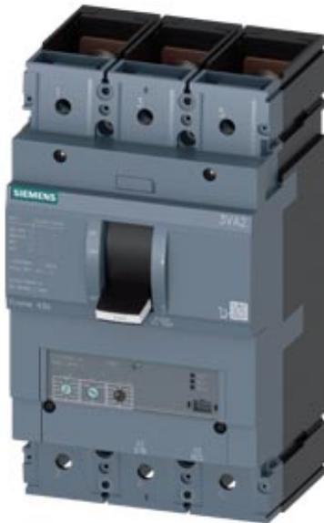
Disjoncteur 3VA2 CEI cadre 630 classe de coupure M Icu=55kA à 415V 3 pôles, protection de moteur ETU350M, LSI, In=500A protection contre les surcharges Ir=200A...500A protection contre les courts-circuits Isd=3...15 x Ir, li=15 x In plage de raccordement par vis déclencheur voltométrique (STL) 110-127V CC, CA 50/60Hz 2 interrupteurs auxiliaires HQ
