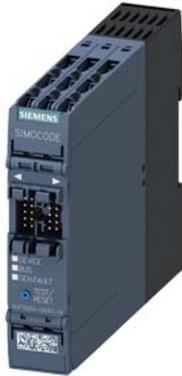
Grundgerät SIMOCODE pro S, PROFIBUS DP-Schnittstelle 1,5 MBit/s, 4E/2A frei parametrierbar, US: 110...240 V AC/DC, Eingang für Thermistoranschluss monostabile Relais-Ausgänge, erweiterbar durch ein Multifunktionsmodul
