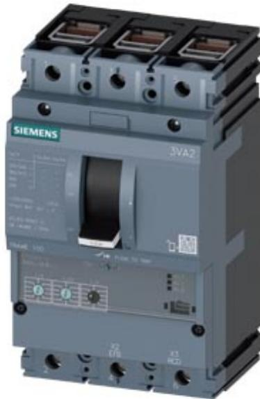
Disjoncteur 3VA2 CEI Frame 100 Classe de coupure M Icu=55 kA à 415 V 3 pôles, protection des installations ETU320, LI, In=63 A Protection contre les surcharges Ir=25A...63A Protection contre les courts-circuits Ii=1,5...12 x In raccordement par bornes déclencheur voltmétrique (STL) 12-30V CC, 24V CA 50/60Hz 2 interrupteurs auxiliaires HQ 1 indicateur de déclenchement HQ 1 contact de signalisation de déclencheur de protection
