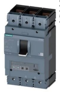
Disjoncteur 3VA2 CEI cadre 630 classe de coupure C Icu=110kA à 415V 3 pôles, protection des installations ETU350, LSI, In=630A protection contre les surcharges Ir=250A...630A protection contre les courts-circuits Isd=1,5...9 x Ir, Ii=9 x In plage de raccordement par vis déclencheur voltmétrique (STL) 110-127V CC, CA 50/60Hz 2 interrupteurs auxiliaires HQ 1 indicateur de déclenchement HQ 1 contact de signalisation de déclencheur de protection
