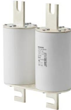
SITOR-Sicherungseinsatz, mit geschlitzten Messerkontakten, 2 x NH3L, In: 1000 A, aR, Un DC: 1250 V, Stirnkennmelder
