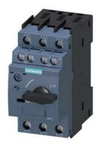
Leistungsschalter Baugröße S00 für den Motorschutz, CLASS 10 A-Auslöser 2,2...3,2 A N-Auslöser 42 A Schraubanschluss Standardschaltvermögen mit querliegenden Hilfsschalter 1S+1Ö
