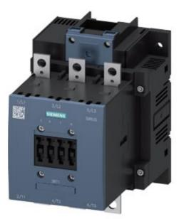
contacteur de puissance, AC-3 150 A, 75 kW / 400 V CA (50-60 Hz) / circuit de commande CC UC 220-240 V sans contacts auxiliaires 3 pôles, Taille S6 Raccordement par barres Entraînement : conventionnel
