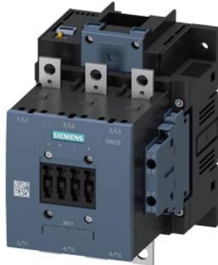
Leistungsschütz, AC-3 150 A, 75 kW / 400 V AC (50-60 Hz) / DC-Betätigung AC/DC 96-127 V Hilfskontakte 2 NO + 2 NC 3-polig, Baugröße S6 Schienenanschlüsse Antrieb: elektronisch mit SPS-Schnittstelle DC 24 V Schraubanschluss
