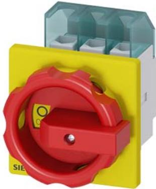
SENTRON, Lasttrennschalter 3LD, Not-Aus-Schalter, 3-polig, I<sub>n</sub>: 32 A, Betriebsleistung / bei AC-23 A bei 400V: 11,5 kW, Frontbefestigt, Drehantrieb, rot/gelb, 4-Loch Befestigung der Handhabe
