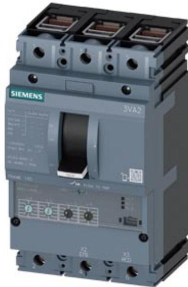
Disjoncteur 3VA2 CEI Frame 160 Classe de coupure M Icu=55 kA à 415 V 3 pôles, protection des installations ETU350, LSI, In=100A Protection contre les surcharges Ir=40A...100A Protection contre les courts-circuits Isd=1,5...10 x Ir, li=12 x In raccordement par bornes déclencheur voltmétrique (STL) 220-250V CC, 208-277V CA 2 interrupteurs auxiliaires HQ 1 indicateur de déclenchement HQ 1 contact de signalisation de déclencheur de protection
