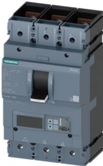
Disjoncteur 3VA2 CEI cadre 630 classe de coupure H Icu=85kA à 415V 3 pôles, protection des installations ETU550, LSI, In=630A protection contre les surcharges Ir=250A...630A protection contre les courts-circuits I<sub>sd</sub>=0,6..9 x I<sub>n</sub>, I<sub>i</sub>=1,5..9 x I<sub>n</sub> protection du neutre en option avec transformateur de courant externe, jusqu'à 160% plage de raccordement par vis 2 interrupteurs auxiliaires HP 1 indicateur de déclenchement HP
