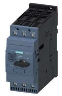
Leistungsschalter Baugröße S2 für den Trafoschutz A-Auslöser 54...65 A N-Auslöser 1040 A Schraubanschluss Standardschaltvermögen
