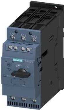
Leistungsschalter Baugröße S2 für den Motorschutz, CLASS 10 A-Auslöser 12...17 A N-Auslöser 260 A Schraubanschluss erhöhtes Schaltvermögen mit querliegenden Hilfsschalter 1S+1Ö
