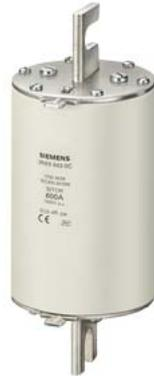
SITOR-Sicherungseinsatz, mit geschlitzten Messerkontakten, NH3, In: 250 A, aR, Un AC: 1500 V, Un DC: 900 V, Stirnkennmelder
