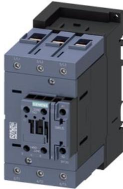
Leistungsschütz, AC-3 110 A, 55 kW / 400 V 1 S + 1 Ö , AC/DC 20-33 V kommunikationsfähig 3-polig, 3S, Baugröße S3 Schraubanschluss Varistor integriert
