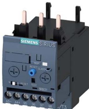
Überlastrelais 3...12 A elektronisch für Motorschutz Baugröße S0, CLASS 5...30 Schützenbau Hauptstromkreis: Schraub Hilfsstromkreis: Schraub Hand-Automatik-RESET interne Erdschlusserkennung
