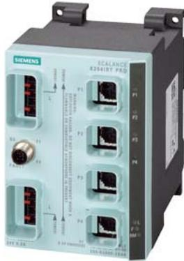
SCALANCE X204IRT PRO, managed IE IRT Switch in Schutzart IP65/67, 4x 10/100 Mbit/s Push Pull RJ45 Ports, Fehlermeldekontakt mit Set-Taster; redundante Spannungsversorgung; PROFINET IO Device, Netzwerk-Management, Redundanz-Manager integriert, inkl. elektron. Handbuch auf CD-ROM, C-PLUG optional.
