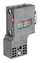
SIMATIC DP, Anschlussstecker für PROFIBUS bis 12 MBit/s 90° Kabelabgang, 15,8x 59x 35,6mm (BxHxT), Schneidklemmtechnik Fast-Connect, ohne PG-Buchse 100 Stück je Verpackungseinheit
