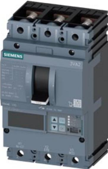
Disjoncteur 3VA2 CEI Frame 100 Classe de coupure M Icu=55 kA à 415 V 3 pôles, protection des installations ETU850, LSI, In=63A Protection contre les surcharges Ir=25A...63A Protection contre les courts-circuits Isd=0,6..10x In, li=1,5..12x In protection du neutre en option avec transformateur de courant Plage de raccordement par vis déclencheur voltmétrique (STL) 12-30V CC; 24V CA 50/60Hz 2 interrupteurs auxiliaires HQ 1 indicateur de déclenchement HQ 1 contact de signalisation de déclenchement
