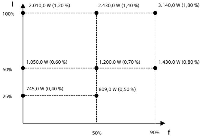
Die Prozentwerte geben die Verluste in Bezug auf die Bemessungscheinleistung des Umrichters an.
