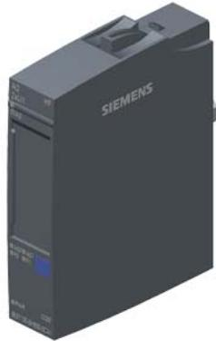
SIMATIC ET 200SP, analoges Ausgangsmodul, AQ 2x U/I High Feature passend für BU-Typ A0, A1, Farbcode CC00, Kanal-Diagnose, 16 Bit, +/- 0,1%
