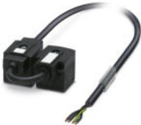
Câble connecteur électrovanne double, 4-pôles, PUR/PVC, noir, extrémité libre, sur Connecteur pour électrovanne A, avec 1 LED, câblé avec Diode zéner et Connecteur pour électrovanne A, avec 1 LED, câblé avec Diode zéner, longueur de câble: 5 m, écart entre connecteurs pour électrovanne: 0,15 m
