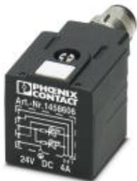
Connecteur pour électrovannes, 5-pôles, Connecteur coudé M12 SPEEDCONN, détrompage A, sur Connecteur pour électrovanne AD (pressostat), avec 2 LED
