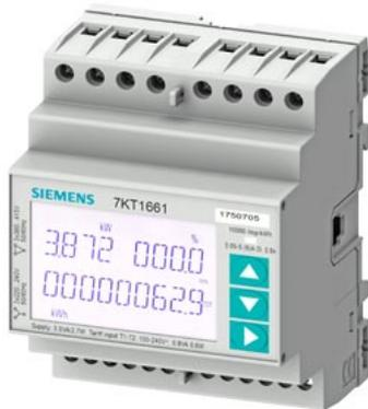
SETRON, Messgerät, 7KT PAC1600, LCD, L-L: 400 V, L-N: 230 V, 5 A, Hutschienengerät, 3-phasig, S0, Schein- / Wirk- / Blindenergie, eigenversorgt, Schraubanschluss
