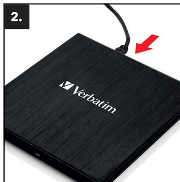
Connectez le câble d'interface USB à l'appareil.
