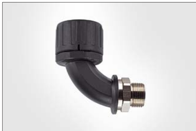
Raccord HelaGuard HG-90M coudé à 90° avec filetage externe tournant, IP66.
