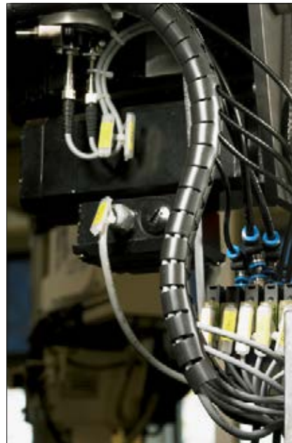
Une protection accrue et plus flexible des dériviations quel que soit le point de sortie sur la gaine.
