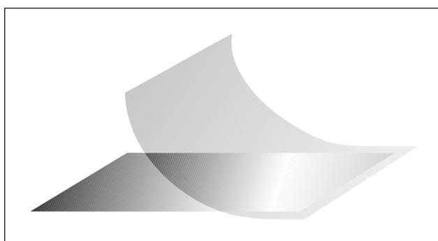
L'étiquette argentée imprimée (mat 951A) est protégée par le film de protection transparent (mat 951B).
